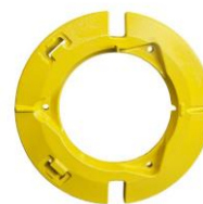
Obciążnik kołowy waga 120 kg
