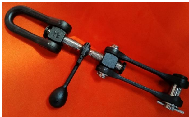
Sprzęg śrubowy do zespołów łączeniowych wagonów
