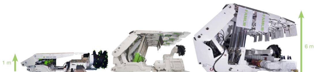
Obudowy ścianowe wraz z kombajnami produkcji Grupy FAMUR
