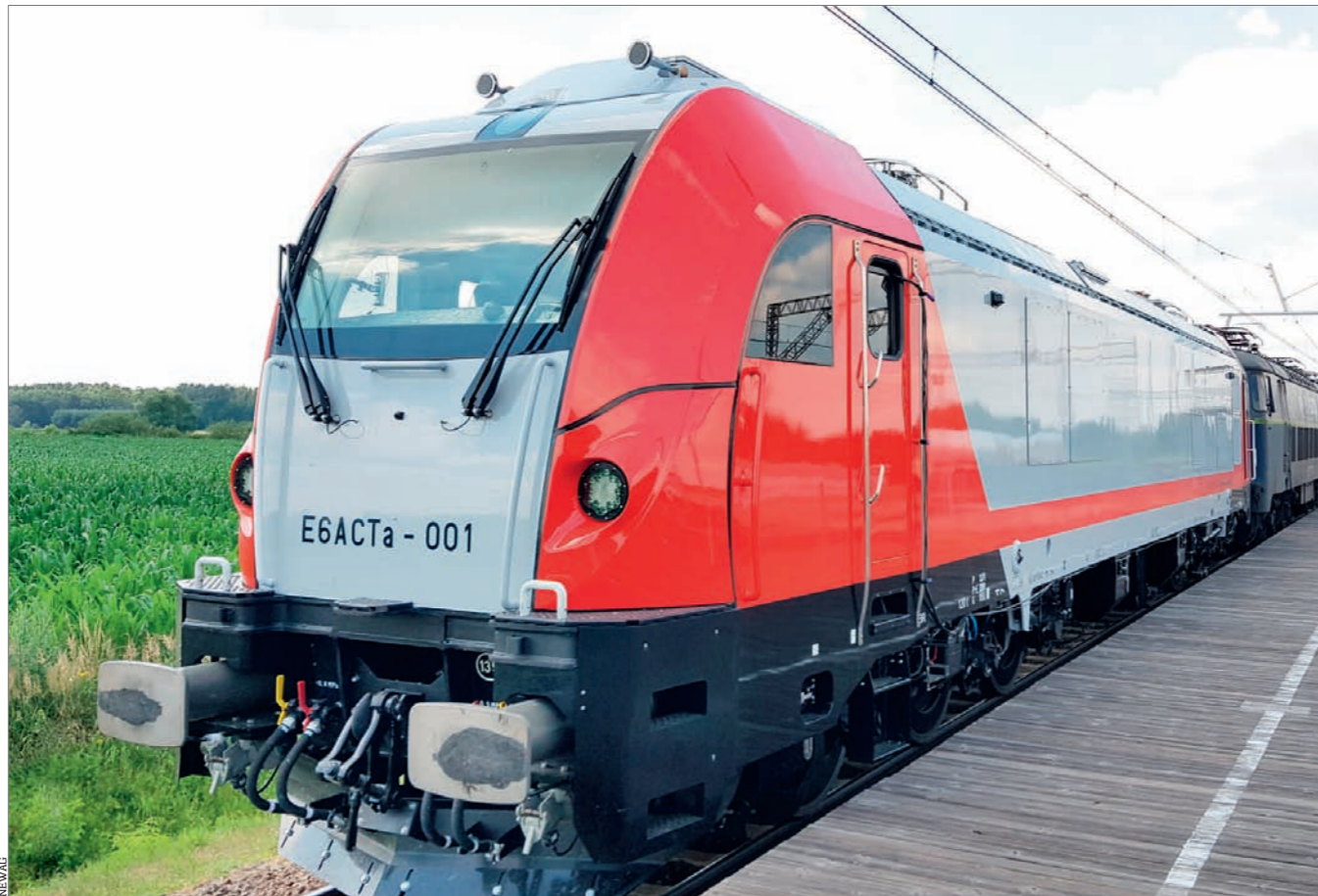
Lokomotywa Dragon 2 firmy Newag używa energoelektroniki na bazie SiC, dostarczonej przez spółkę Medcom
