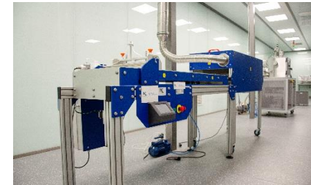
Fot. 104 Element do produkcji na ułamkowo techniczną skalę fotowoltaicznego ogniwa tandemowego
