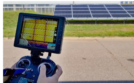
Fot. 30 Termowizyjny przegląd dronem instalacji PV
