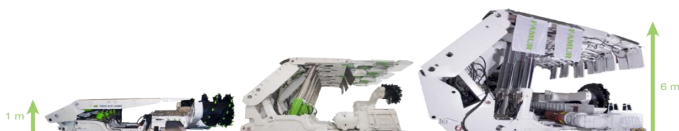
Obudowy ścianowe wraz z kombajnami.
