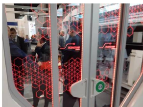
Drzwi do wagonu z systemem podświetlenia krawędziowego
