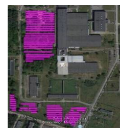
MPWiK – planowana instalacja fotowoltaiczna na obiekcie Południe
