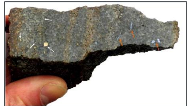
Rys. 9: Warstwowa mineralizacja miedzi w słabo skonsolidowanej warstwie Jyske Ås.
